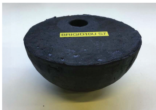
Fantoma para aplicações de Microwave Breast Imaging que simula as características eletromagnéticas de uma mama, para testar o sistema num cenário controlado mas realista
